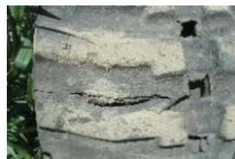
切断、切れ目補修などゴムクローラーの補修、再生を致します。状況からよりよいご提案を致します。
