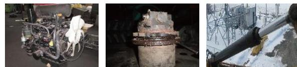
エンジン・走行モーター・シリンダーラジエターのオーバーホールシリンダー内圧縮比の下がったエンジンの再生やコア洗浄も含めたラジエターの修理を致します。
